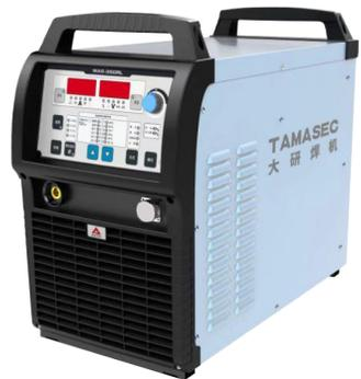
NBC-350RL焊机具有超低飞溅、快速点焊和恒压三种焊接方式。非常适合碳钢、镀锌板薄板的焊接。该型号焊机性价比最高，焊接碳钢0.7~2.5mm的工件最佳，飞溅小、成型美观。当焊接厚度超过3mm或焊接电流大于180A以上时，飞溅逐渐变大。焊接最大厚板不超过8mm。
