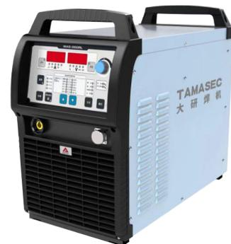
Pulse MIG-350/500RP焊机具有单脉冲、双脉冲和恒压共三种焊接方式。可焊接碳钢、不锈钢、铝及其合金、铜及其合金等有色金属。Pulse MIG-350RP焊机可进行板厚2~6mm铝合金工件的脉冲无飞溅焊接，成型美观。焊接板厚超过8mm时，请选择Pulse MIG-500RP焊机。
