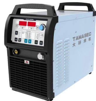
MAG-350Pro焊机相较于之前的数字化焊机，整机的系统架构做了大幅调整，主控板全新升级为FPGA芯片为核心，对于工业级产品而言，FPGA芯片稳定性要远远高于ARM芯片或者DSP芯片，从硬件层面提升了系统的稳定可靠。Pro系列焊机还具有远程升级功能，可根据客户要求进行工艺参数更改，并进行远程升级。焊接方式具有单脉冲、短弧脉冲、恒熔深、快速点焊和恒压共五种。可焊接碳钢、不锈钢等材料。
