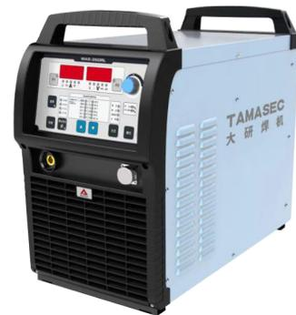
NBC-350/500RP焊机具有单脉冲、恒压共两种焊接方式。可焊接碳钢、不锈钢、镀锌板等金属。还可以使用碳钢药芯焊丝、不锈钢药芯焊丝进行焊接。NBC-350RP焊机专门为碳钢和不锈钢焊接设计的一款高性价比焊机，可以进行厚板2.5~8mm工件的脉冲无飞溅焊接，成型美观，焊接厚度超过8mm时，请选择NBC-500RP焊机。
